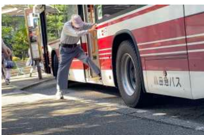
降車口と歩道の間に大きな隙間
